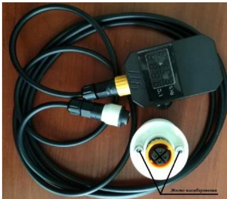
Рисунок 2 – Схема пломбирования термогигрометров «УТГ»
