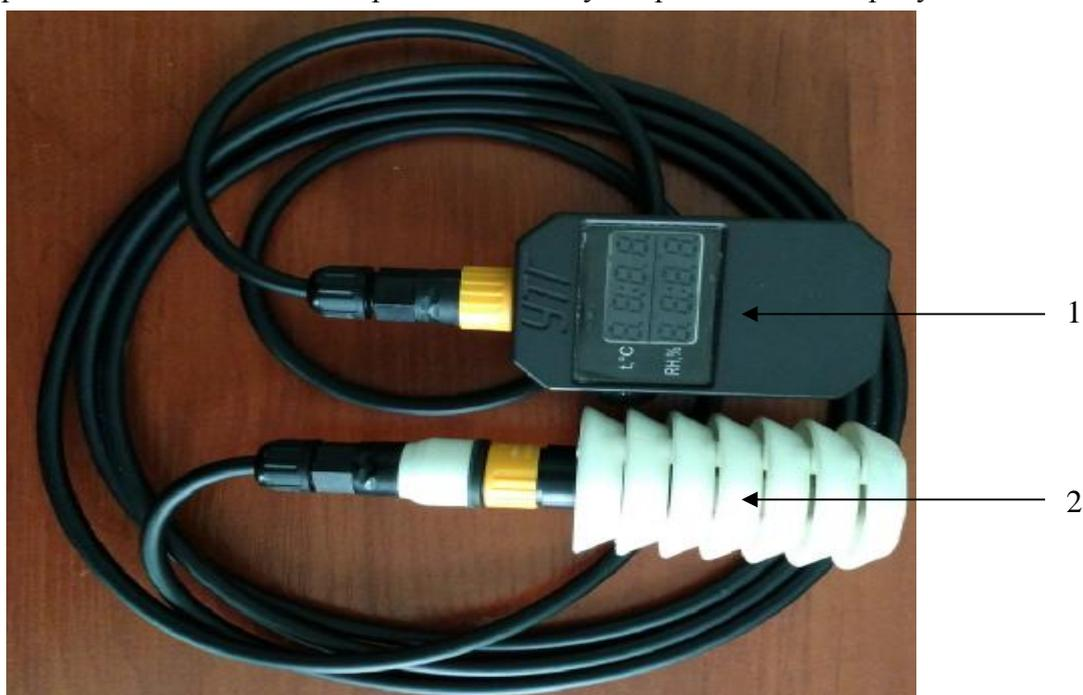
Рисунок 1 – Общий вид термогигрометров «УТГ»
